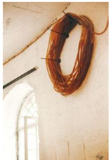
Abb. 3: Die „spiralförmige Mehrfachwindung“ des Honigschlauches in dem Raum der FIU. Der Schlauch führt dicht unter der Decke wieder zurück zur Honigpumpe.
